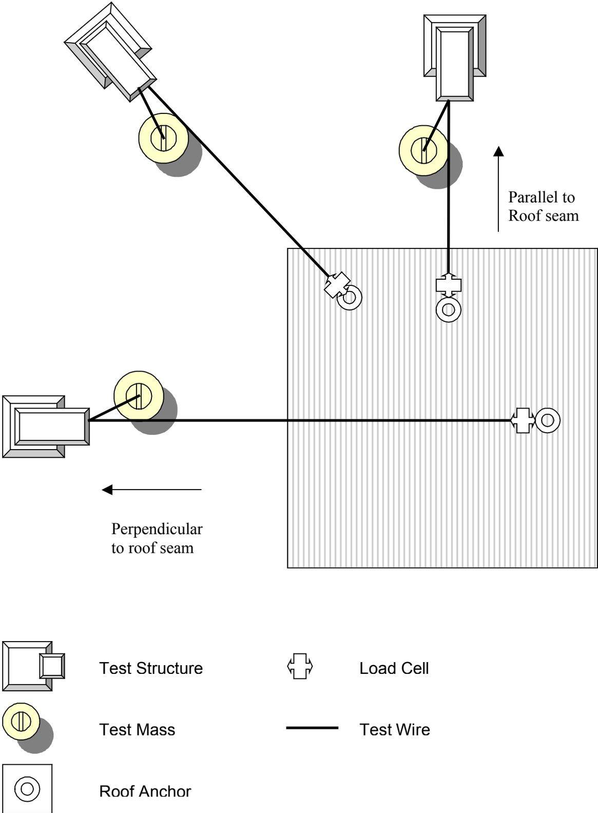
**FIG 2 - TYPICAL DYNAMIC TEST SET UP - PLAN VIEW**
